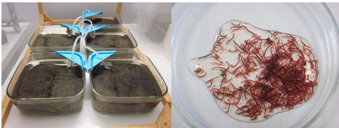
Figura 8. Test di bioaccumulo con Chironomus riparius : allestimento delle repliche (sinistra) e separazione delle larve alla fine dell'esposizione per la l'analisi delle concentrazioni di mercurio (destra).
