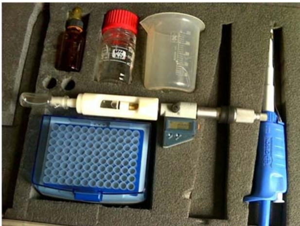
Figura 5. Microburetta portatile per la determinazione in campo dell'alcalinità.
