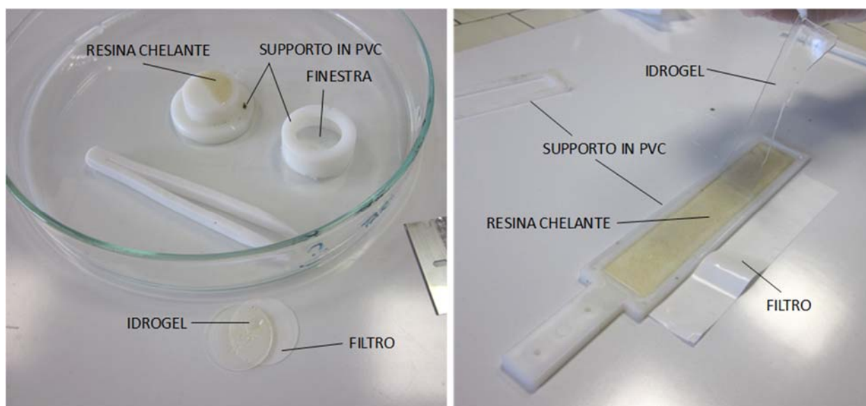
Figura 1. Unità di DGT impiegate per l'analisi del mercurio. A sinistra: unità di tipo "piston"; a destra: unità di tipo "probe".
