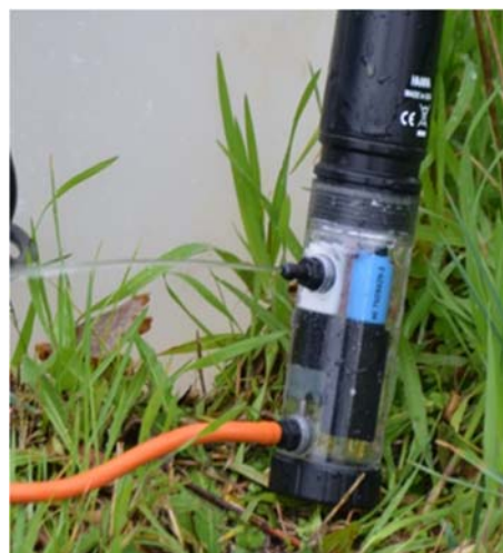
Figura 3. Sonde multiparametriche in celle di flusso per la misura dei parametri chimico-fisici in situ
