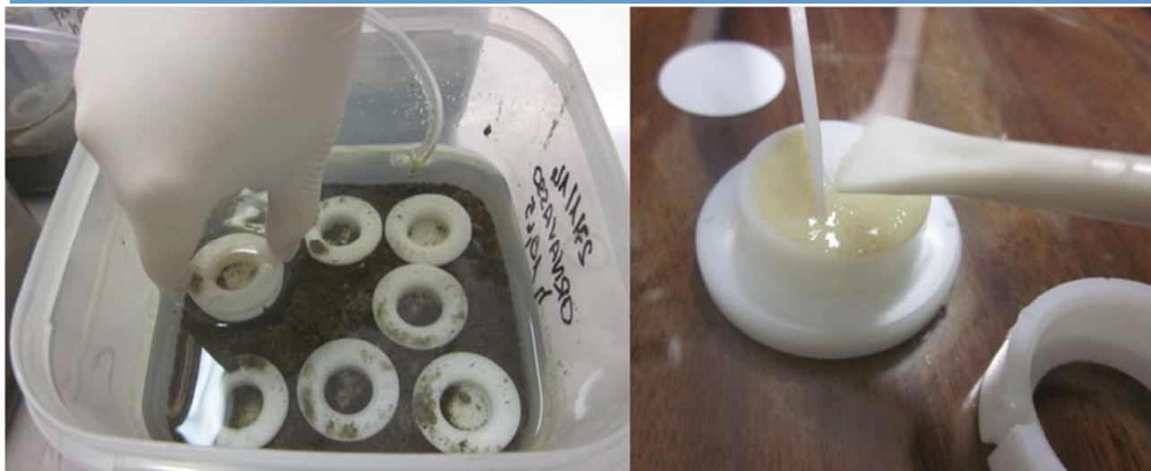
Figura 4. Esposizione delle DGT nei sedimenti del Toce in laboratorio (sinistra) e sezionamento della resina prima dell'analisi (destra).
